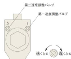
ドライバーなどでねじを回してスピードを調整。
