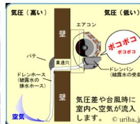
マンションや高気密住宅などで気になるポコポコ音は、ドレンホース(室内機の結露水を外へ排水するホース)によって引き起こされます。室内外の気圧差や台風などの強風時に、ドレンホースの外側から室内に向かって外気が入ってきてしまい、その空気がエアコン内部を通過する際、エアコンからポコポコと音が鳴ることがあります。
